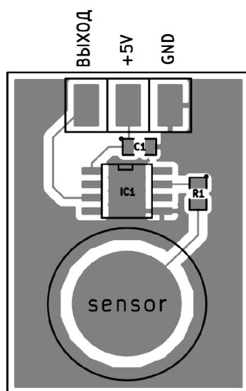
Данный модуль не имеет встроенного стабилизатора напряжения, поэтому напряжение питания не должно превышать 5 В, во избежание выхода из строя.
