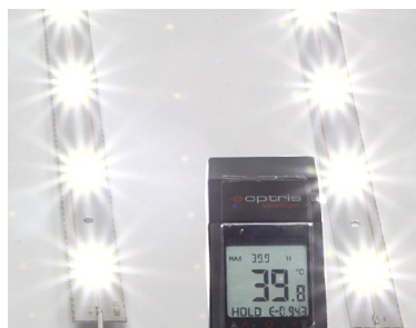
Температура на радиаторах светодиодов после 30 минут работы
