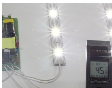
Температура радиатора драйвера после 30 минут работы
