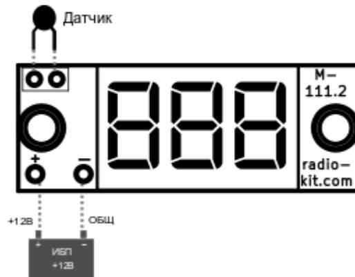
Внимание: Датчик запаянный на плату может показывать на несколько градусов больше, за счет нагрева самого модуля. В избежании нежелательного нагрева датчика необходимо подключать к модулю с помощью двух проводов.
