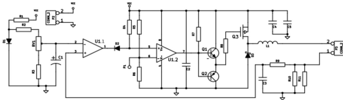
Схема построена на интегральном двойном компараторе LM393, включенным по схеме понижающего преобразователя.
