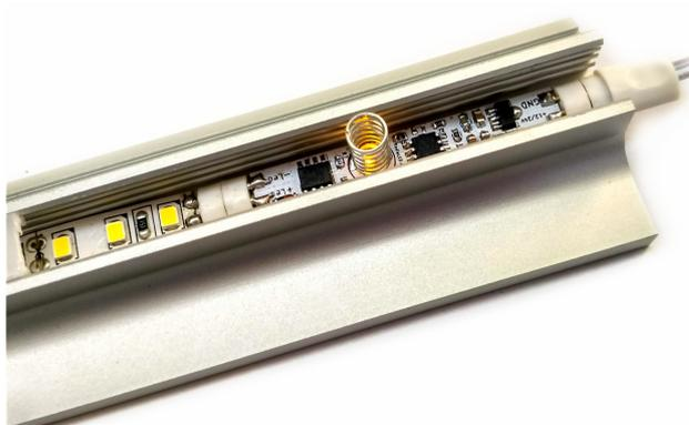
На фото приведен пример подключения димера M298-20YR. При подключении с помощью пайки провода от блока питания подводятся к контактам {GND/12/24V}, а лента — к контактам {LED-/LED+} соответственно.
