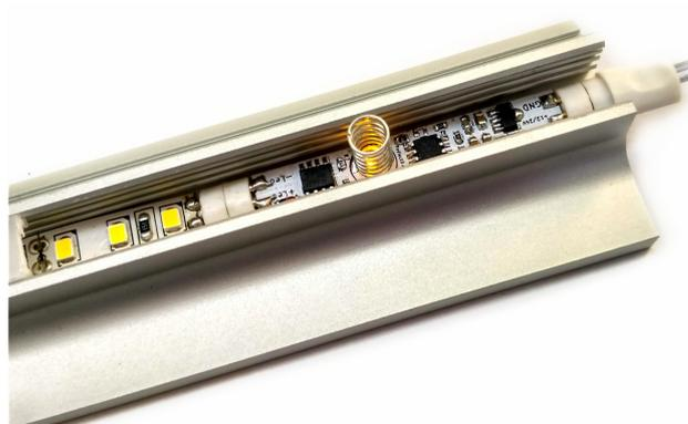
На фото приведен пример подключения димера M298-8MM5A-20YR. При подключении с помощью пайки провода от блока питания подводятся к контактам {+12/24V} и {GND}, а лента — к контактам {+LED} и {-LED} соответственно.
