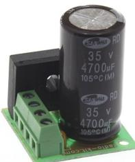
На основе печатной платы PCB114 можно собрать однополярный выпрямитель, предназначенный для преобразования и сглаживания пульсаций переменного входного электрического тока в постоянный.
