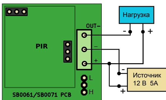
Схема подключения модуля
