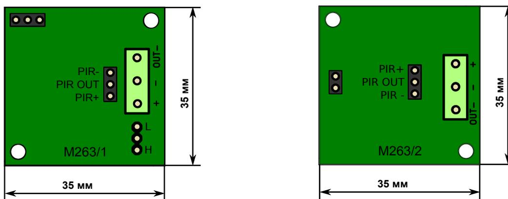
Следует соблюдать распиновку PIR-датчика и модуля, как показано на рисунках. Названия контактов датчика нанесены на одной из его сторон.
