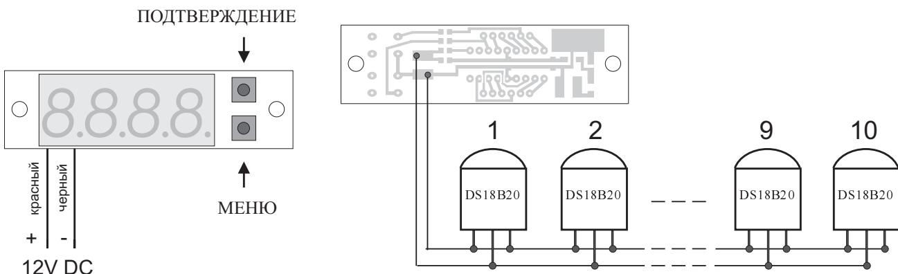
Прибор содержит четырехразрядный индикатор и две кнопки управления. В основном режиме в трех старших разрядах индицируется значение температуры, а в младшем мигающем номер датчика. Если датчиков 10, то десятый номер индицируется мигающей черточкой. Нижняя кнопка МЕНЮ, верхняя ПОДТВЕРЖДЕНИЕ.
